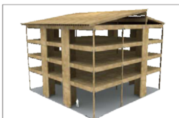
VÄDERSKYDDAD BYGGNATION. När mellanbjälklag monteras är taket redan på plats. Det garanterar torrt bygge.
